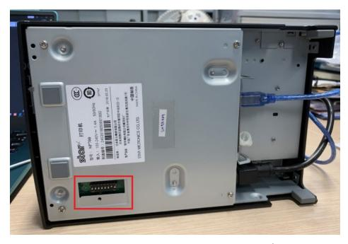
2. Factory default ของ dip switch จะเป็นตามภาพด้านล่างแยกตามแต่ละรุ่นเครื่องพิมพ์ หากต้องการตั้งไม่ให้ตัดกระดาษ อัตโนมัติ (ในกรณีของเครื่องพิมพ์รุ่น SP747) ต้องปรับ dip switch 1 bit 2 จาก OFF ให้เป็น ON ตามภาพด้านล่าง
